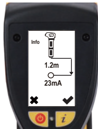
Appuyez sur le bouton i pour obtenir une mesure de profondeur et de courant.
