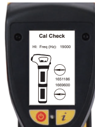
La fonction d'autotest vérifie que les relevés du récepteur sont conformes à l'étalonnage.
