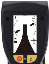
L'écran de localisation standard affiche l'indicateur de réponse maximale et le compas la direction du réseau.
